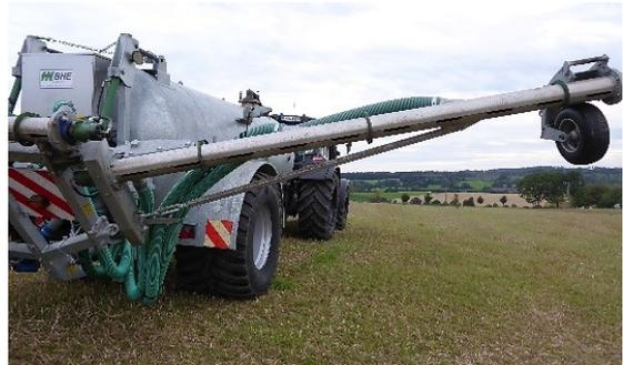
Abbildung 5 Verteilerrohr mit Stützrad
