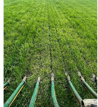
Abbildung 1 Streifenförmige Ablage des Güllebandes mit dem Schleppschuhverteiler
