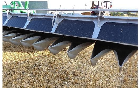
Abbildung 4 Verteilern mit Schlepsschuhen
