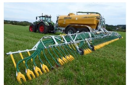
Abbildung 2 Gleitkufe mit Doppeldüse
