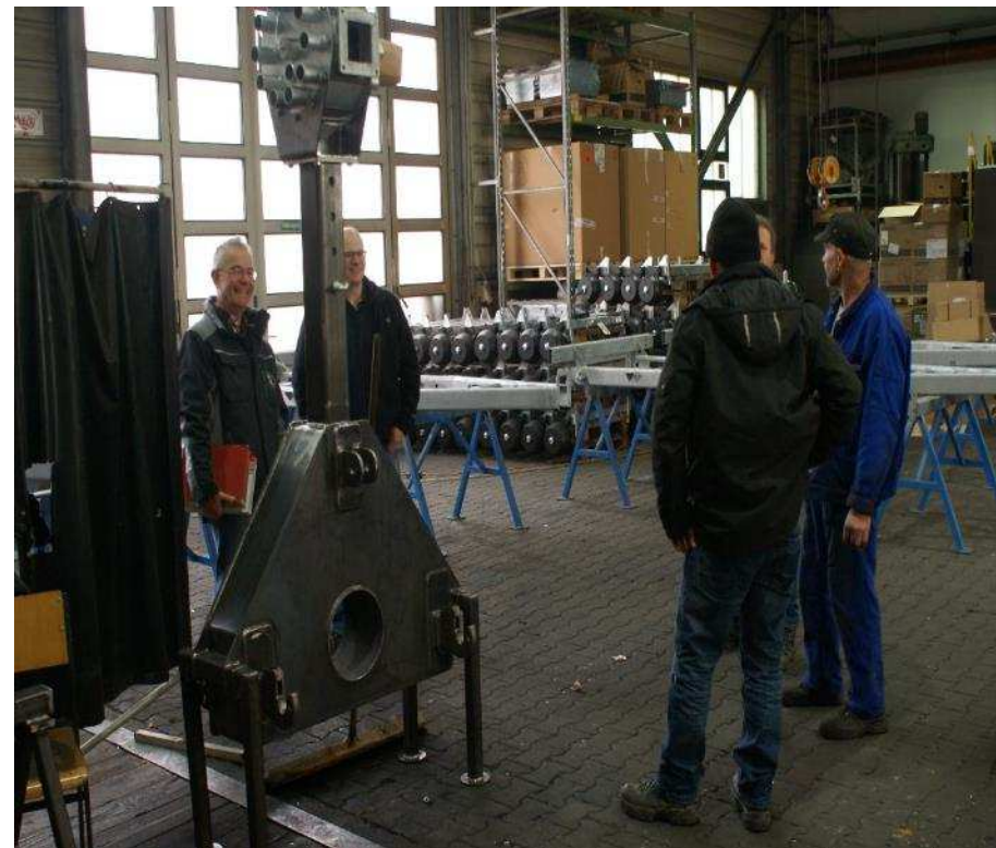
Zwischenbock mit Verteiler zum Koppeln der Anbaugeräte
