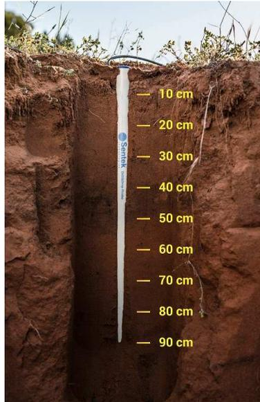
Meteobot® Hydro kann mit den Bodenfeuchtesensoren des führenden australischen Herstellers Sentek ausgestattet werden. Sie zeigen den Bodenwassergehalt alle 10 cm Tiefe an – z.B. bei 10, 20, 30, ... bis zu 120 cm. Der Wassergehalt wird in Litern (mm) pro Quadratmeter angezeigt. Auf diese Weise haben Sie Informationen, wie viel Wasser Sie zu einem bestimmten Zeitpunkt im Boden zur Verfügung haben.
